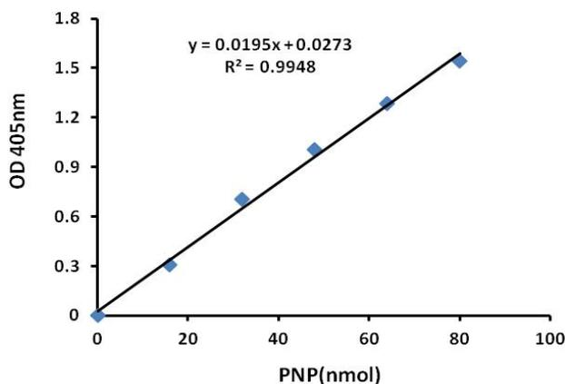
2、定义: 每克土壤每小时水解 PNPP 产生 1nmol 对硝基苯酚 (PNP) 为一个酶活单位。
